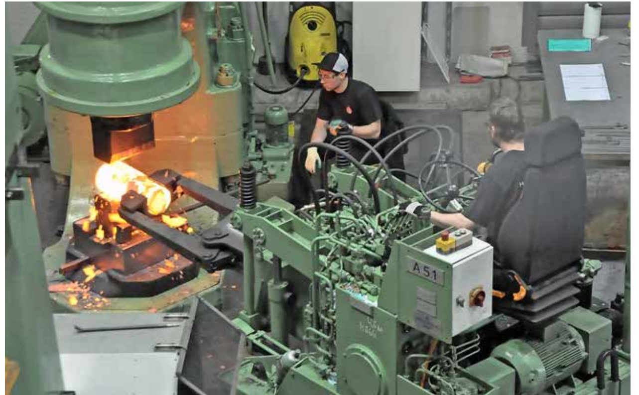
Das Schmiede-Team lässt den sogenannten Bär auf den entstehenden Klöppel fallen – mit einer Wucht von bis zu 100 Tonnen. Dadurch wird die Stange des Klöppels länger und länger. Später folgt die Formung des Ballens.
